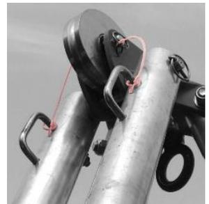
Cette poulie peut maintenant être démontée aisément pour passer le câble lors de chaque utilisation et ce, sans démonter les pieds.
